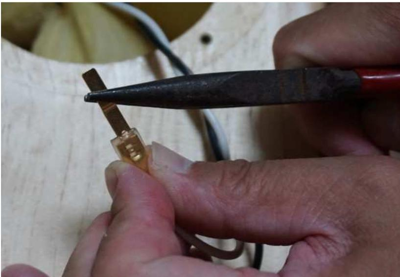
ケーブルに付いたソケットに端子をペンチなどで挟んで差し込む。結構硬いので、硬すぎる場合にはソケットを千枚通しなどで若干広げておくと良い
